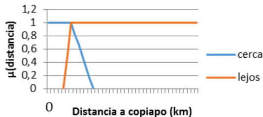
Figura 7. Definición alternativa de funciones de pertenencia trapezoidales para el concepto distancia y las etiquetas lingüísticas cerca y lejos definidos sobre el atributo distancia del nivel región.
